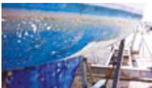
Blærer i og avskalling av maling
