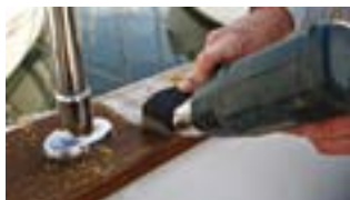
Fjern gammel lakk med varmluftpistol
