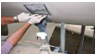
Våtskrap for å fjerne gammelt bunnstoff
